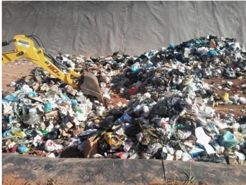
Figura 97 - Procedimento de quarteamento realizado.
