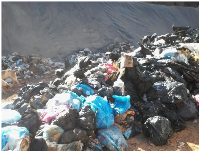
Figura 98 - Procedimento de quarteamento realizado.
