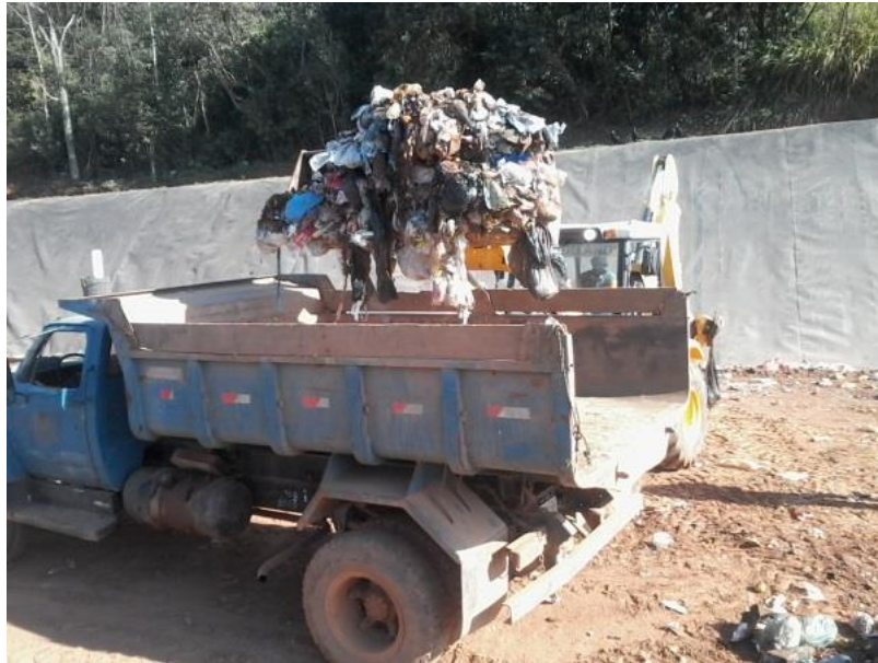
Figura 99 - Procedimento de quarteamento realizado.
